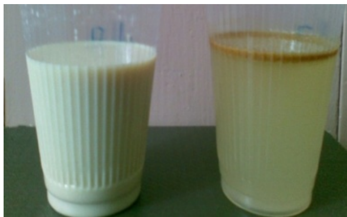
Рис. 4. Отработанная СОЖ до и после подкисления а) pH = 9; б) pH = 3 (после 5 суток)
