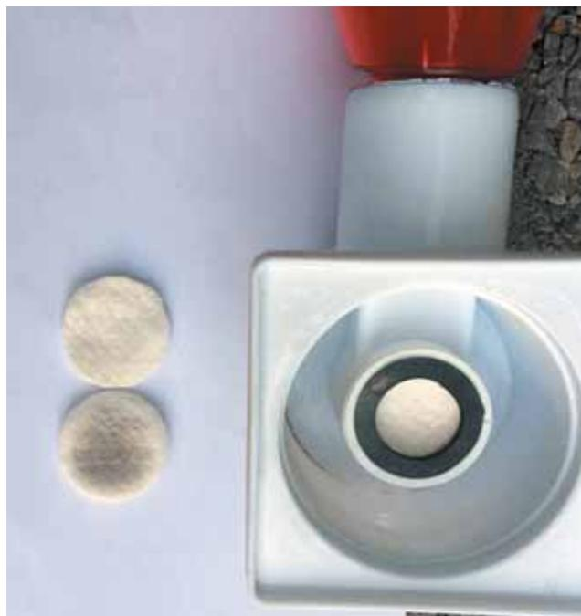
▲ Рис. 2. Насадка для крепления фильтров
